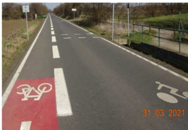
Obr. 53: Doporučený způsob dopravního značení a šířkového uspořádání
